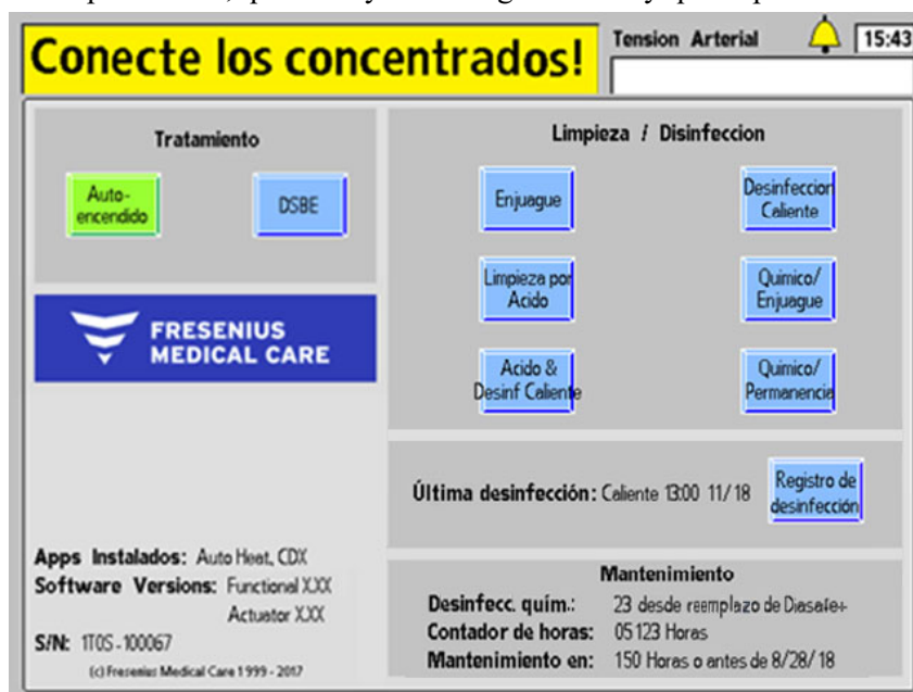
Figura 24 – El programa de encendido automático está esperando la conexión del concentrado
